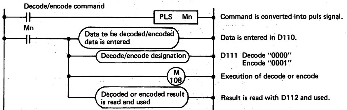
Fig. 5.4.12.1 Decode/Encode Circuit Composition
